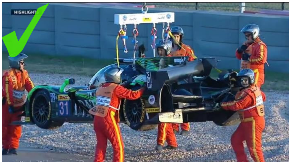
Juiste procedure voor het takelen/evacueren van het voertuig. De baancommissarissen stabiliseren de auto en dit door de auto op de voor- en achtervleugels vast te houden.
